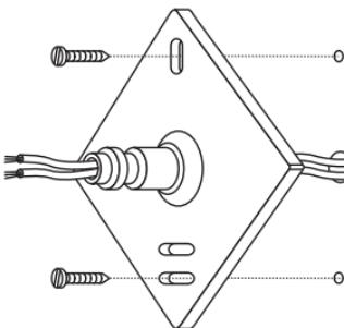
Fig.1 NOTA BENE: Scegliere i tasselli ad espansione idonei per la superficie destinata al montaggio.
