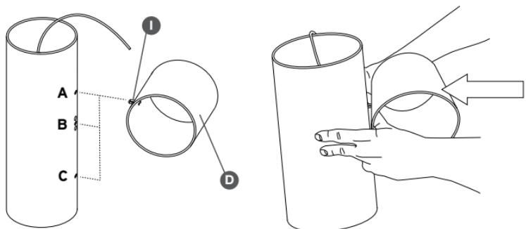
**IT** **Fig.1** Scegliere la posizione di lavoro dell'apparecchio tra le tre previste, inserire quindi il perno (I) della base (D) nel foro scelto del corpo afferrando la base con le due mani come indicato in figura in modo che il perno sia ben centrato rispetto al foro.
