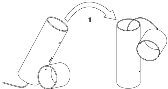
**IT** **Fig.2** Disassemblaggio base (Cambio posizione di lavoro). Afferrando la base (D) con le due mani (come indicato in figura), portare contemporaneamente le dita della mano verso il perno (l) in modo da sganciare il perno dalla molla interna e rimuovere quindi la base. Reinserire la base nella posizione voluta (fig.1).
