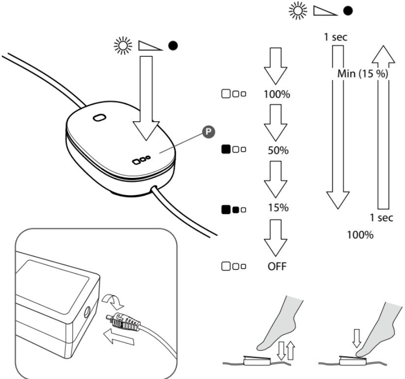
J 図3. 器具を点灯/消灯するにはボタン(P)を押します。明るさの順番：最大(100%) / 50% / 最低(15%) / 消灯。器具が点灯している時にボタンに触れ続けると(少なくとも1秒間)15%まで明るさの度合いが漸減します。望みの明るさに達したならば、指をボタンから離します。メモ：ディマー・メモリーにより、器具が再び点灯する時(壁のスイッチにより点灯する場合も同様)、消灯時の設定と同じ明るさに再び点灯します。ディマー機能はセボタン(P)によってのみアクティブ化されます。器具の消灯時に「停電」が起こった場合、器具が線間電圧へ再接続しても、器具は消灯したままです。
