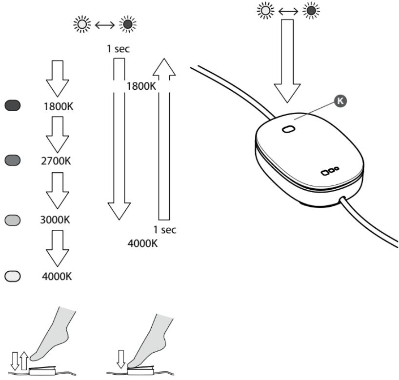
**IT** **Fig.4** Ad apparecchio acceso premendo il pulsante (K) è possibile variare la temperatura colore nella seguente sequenza : 1800K - 2700K - 3000K - 4000K; mantenendo premuto il pulsante per almeno 1 secondo la variazione di temperatura colore avviene in modo graduale.
